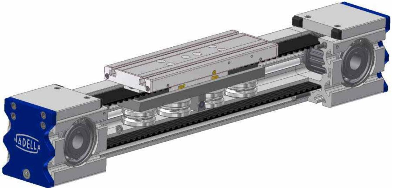
Le pulegge sono alloggiare in due testate identiche che vengono poi saldamente connesse al modulo (la presenza di due pulegge motorizzabili rende molto versatile il montaggio, infatti il cliente potrà motorizzare indistintamente una o l'altra a seconda della configurazione). L'estruso di alluminio utilizzato per realizzare le testate è il medesimo del corpo del modulo.
