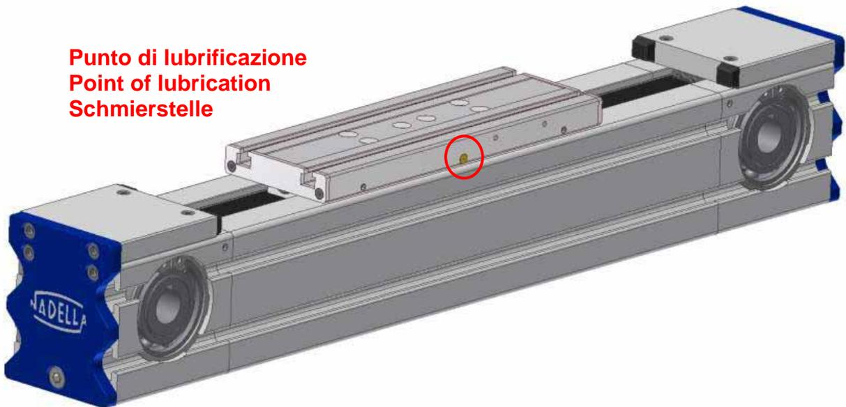
Il modulo lineare viene fornito con la guida interna già lubrificata. Il lubrificante riportato sulle guide garantisce un esercizio senza manutenzione di circa 10000 km (2000 km per il pattino F25).
