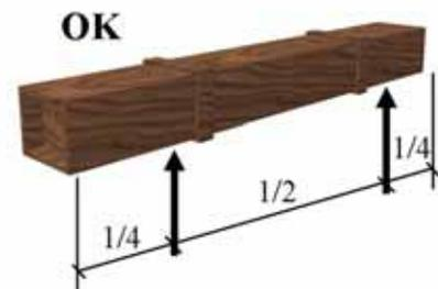
Le casse (ed i moduli una volta estratti) con una lunghezza superiore a 3 m devono essere sollevate ancorandole almeno in tre punti adeguatamente ripartiti onde evitare flessioni eccessive, al centro o ai lati.
